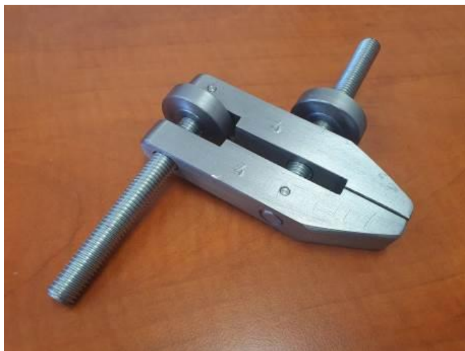
Obr.: Praktická zkouška oboru SM: „Zámečnická svěrka“
